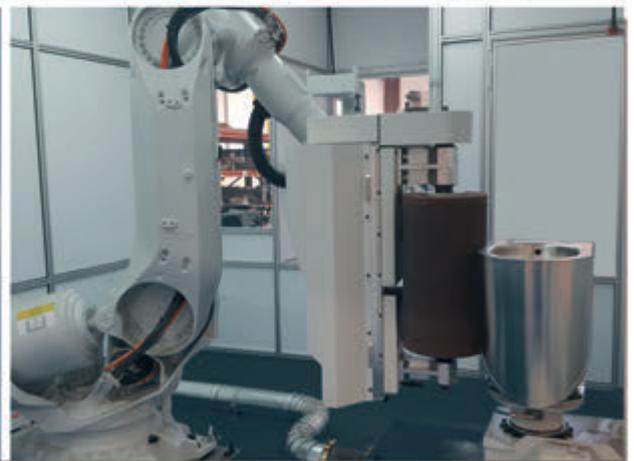
**7-achsige Roboterzelle** mit automatischem Wechsel von bis zu 5 Werkzeugen für die Schweißnahtbearbeitung und die Satinierung von Arbeitsplatten, Wannen, Geschirrspülern, Spülbecken usw. aus Edelstahl für den HORECA-Sektor. Werkstückaufnahme mit einer Kapazität von 2 Teilen zum Be- und Entladen während des Arbeitszyklus.
