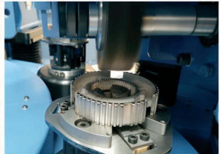
**Maschinen, die speziell für das Entgraten** von bearbeiteten oder gesinterten Teilen, wie z.B. Zahnrädern, entwickelt wurden, um gratfreie Kanten zu gewährleisten und den gewünschten Radius gemäß den Spezifikationen zu erhalten.
