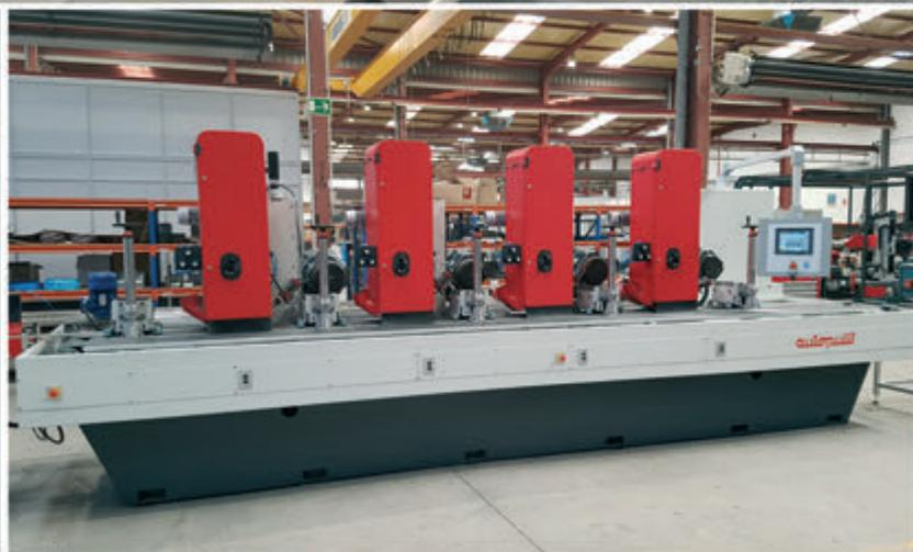
***Bandschleif- und Poliermaschine*** mit Universalköpfen für die Bearbeitung von Vierkantrohren, Platten und Flachteilen.
