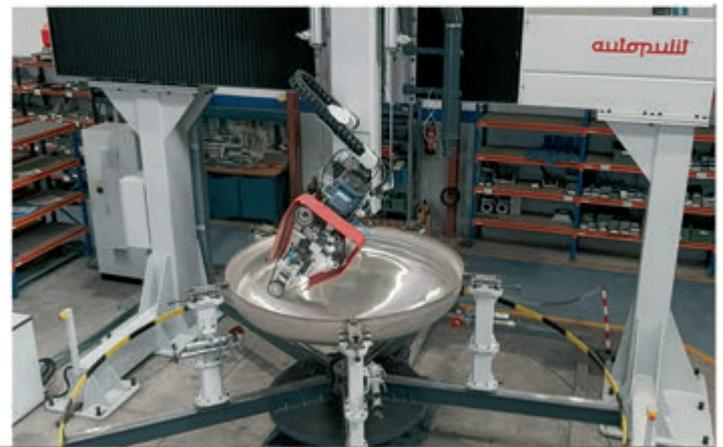
***CNC Maschinen für das Innen- und Außenbandschleifen und Polieren von Böden bis zu Ø6000mm für die Lebensmittel- und Pharmaindustrie, den Flüssigkeitstransport, die chemische Industrie usw.***
