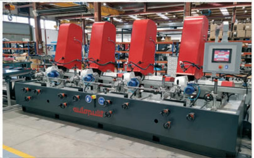
***Bandschleif- und Poliermaschine vom Typ "Centerless" mit Universalköpfen für die Endbearbeitung von Rohren und Rundstäben mit Durchmessern von 6 bis 150 mm mit automatischem Be- und Entladesystem mit Rampenmagazinen.***
