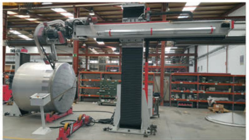
***Maschinen für das Innen- und Außenbandschleifen und Polieren von Böden und Tankkörpern für die Lebensmittel- und Pharmaindustrie, den Flüssigkeitstransport, die chemische Industrie usw.***
