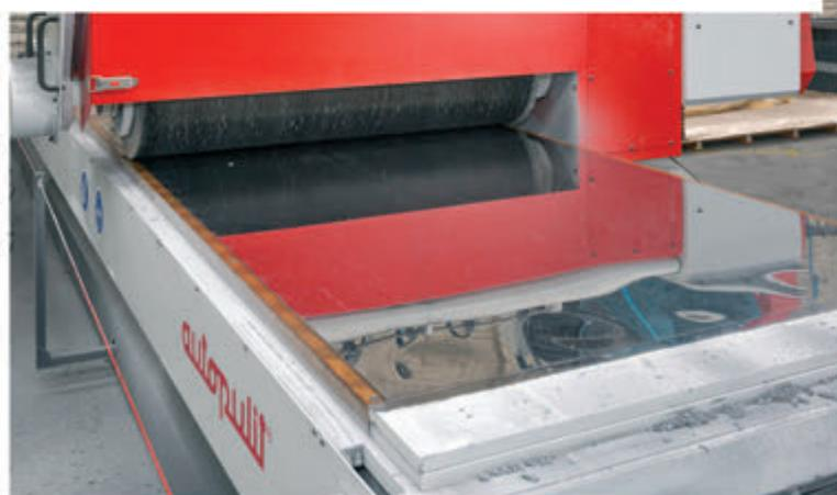
**Poliermaschine für Bleche** und flache Teile. Tisch von 1250×3000 mm mit alternativer Bewegung und Polierkopf mit Oszillation und automatischer Installation der Polierpaste.
