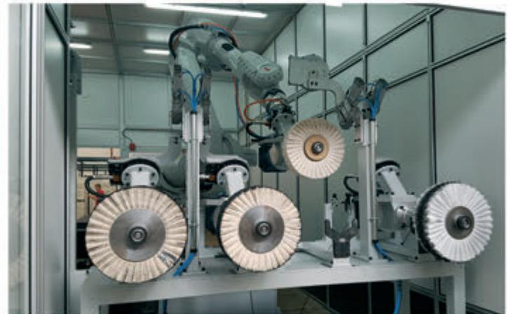
**8-achsige Roboterzelle** mit automatischem Wechsel von bis zu 4 Werkzeugen für die Schweißnahtbearbeitung und die Satinierung von Dunstabzugshauben aus Edelstahl für den HORECA-Sektor. Werkstückaufnahmetisch mit einer Kapazität von 2 Teilen zum Be- und Entladen während des Arbeitszyklus.
