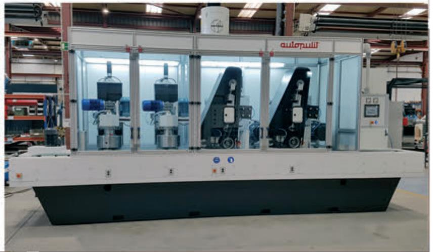
**Bandschleif- und Entgratungsmaschine** für Feinschneid- und Stanzteile für den Automobilssektor, bestehend aus 2 Bandschleifköpfen, 2 Planetenköpfen mit Bürsten und magnetischem Fördertisch für die korrekte Fixierung der Teile.
